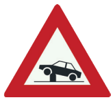
J39 Let op: Elektrische in- en uitschuifbare paal in de rijbaan.
