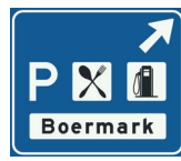
K3 Beslissingsweg- wijzer langs autosnelweg voor de afgaande richting naar een verzorgingsplaats, met de naam van de parkeerplaats en symbolen die de aard van de voorzieningen aangeven
